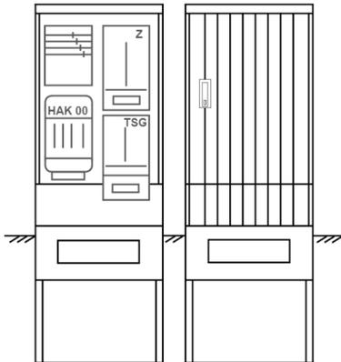
Zähleranschlusssäule für den Außenbereich mit Regendach,
