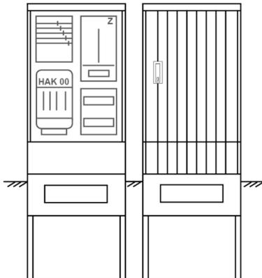
Zähleranschluss säule für den Außenbereich mit Regendach,
