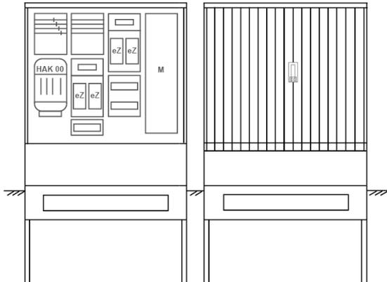
Zähleranschluss säule für den Außenbereich mit Regendach,
