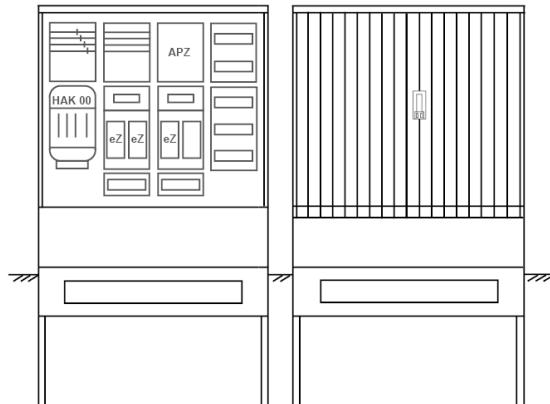
Zähleranschlussäule für den Außenbereich mit Regendach,
