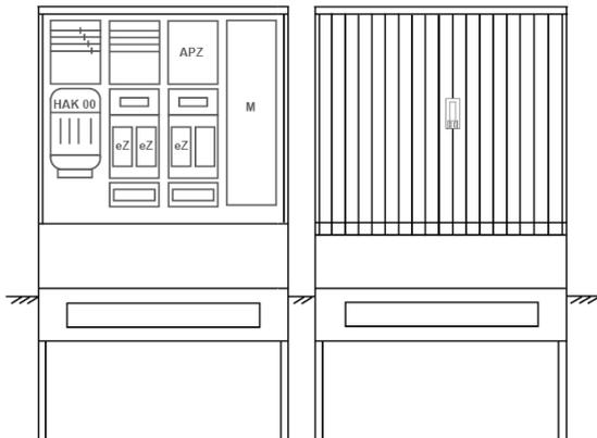
Zähleranschluss säule für den Außenbereich mit Regendach,
