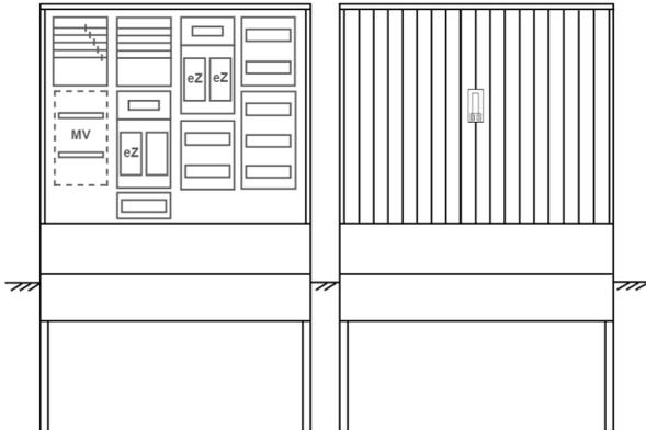
Zähleranschluss säule für den Außenbereich mit Regendach,
