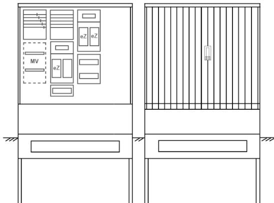
Zähleranschlussäule für den Außenbereich mit Regendach,
