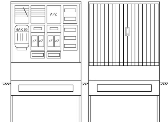
Zähleranschlusssäule für den Außenbereich mit Regendach,
