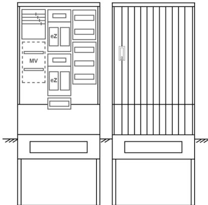
Zähleranschluss säule für den Außenbereich mit Regendach,
