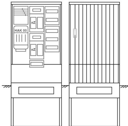
Zähleranschluss säule für den Außenbereich mit Regendach,
