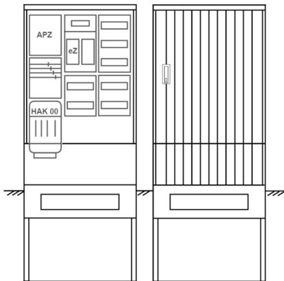
Zähleranschluss säule für den Außenbereich mit Regendach,
