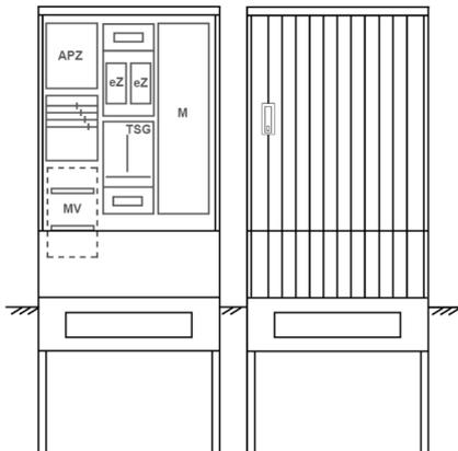
Zähleranschlusssäule für den Außenbereich mit Regendach,
