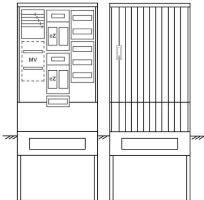
Zähleranschlusssäule für den Außenbereich mit Regendach,
