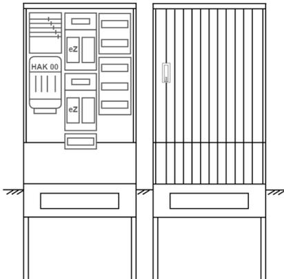
Zähleranschlusssäule für den Außenbereich mit Regendach,
