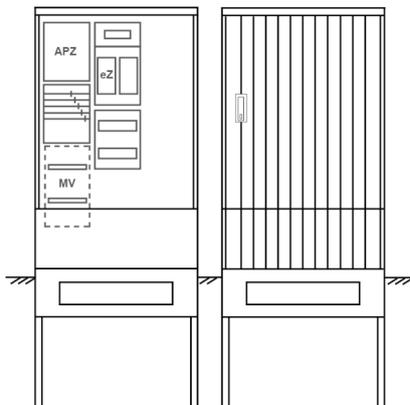
Zähleranschluss säule für den Außenbereich mit Regendach,
