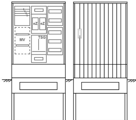
Zähleranschluss säule für den Außenbereich mit Regendach,
