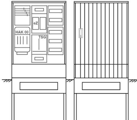
Zähleranschluss säule für den Außenbereich mit Regendach,
