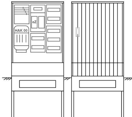
Zähleranschlussäule für den Außenbereich mit Regendach,
