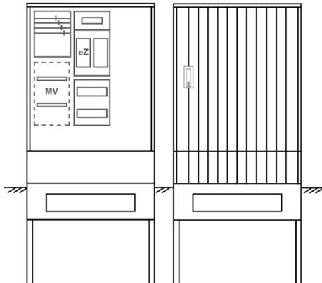
Zähleranschluss säule für den Außenbereich mit Regendach,
