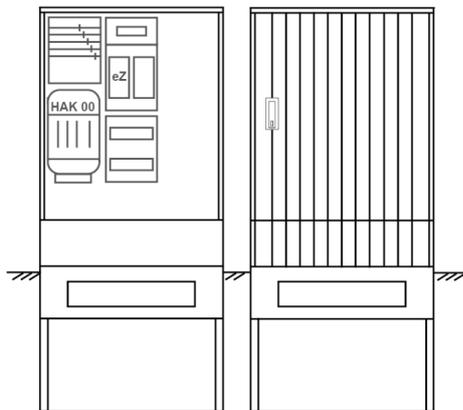
Zähleranschluss säule für den Außenbereich mit Regendach,
