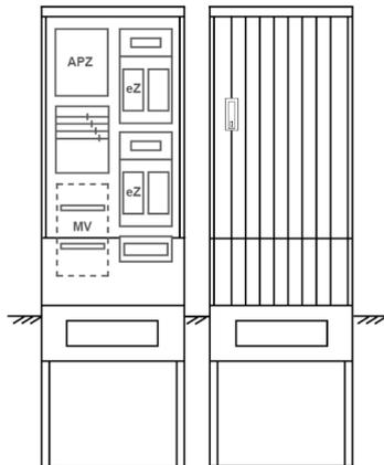
Zähleranschluss säule für den Außenbereich mit Regendach,
