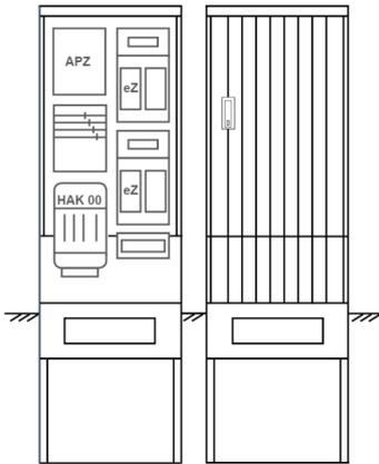
Zähleranschluss säule für den Außenbereich mit Regendach,
