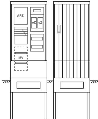
Zähleranschluss säule für den Außenbereich mit Regendach,
