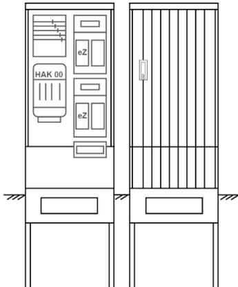
Zähleranschlussssäule für den Außenbereich mit Regendach,
