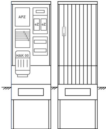
Zähleranschlusssäule für den Außenbereich mit Regendach,
