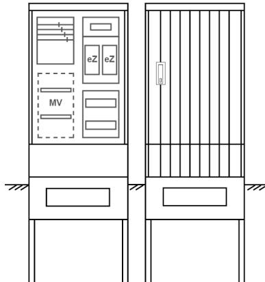
Zähleranschlussäule für den Außenbereich mit Regendach,
