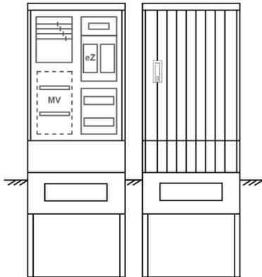
Zähleranschlusssäule für den Außenbereich mit Regendach,
