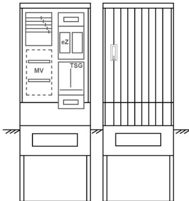
Zähleranschlusssäule für den Außenbereich mit Regendach,
