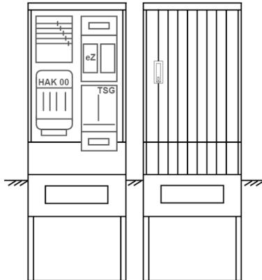
Zähleranschlussäule für den Außenbereich mit Regendach,
