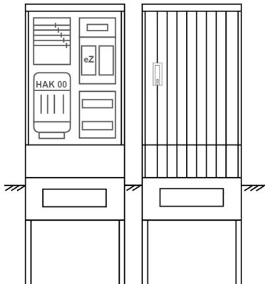
Zähleranschlussäule für den Außenbereich mit Regendach,
