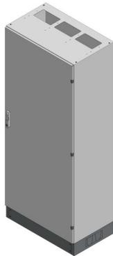
L-SVK3-12-500 Leergehäuse Standverteilung, SVK, BxHxT = 820x1870+130x500 Schutzklasse II, IP54, RAL 7035 Bestehend aus: Gehäuse, Sockel, Einzeltür mit Schwenkhebel für PHZ, Wandhalterung, ohne Flansche
