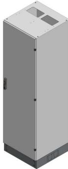
L-SVK2-12-600 Leergehäuse Standverteilung, SVK, BxHxT = 570x1870+130x600 Schutzklasse II, IP54, RAL 7035 Bestehend aus: Gehäuse, Sockel, Einzeltür mit Schwenkhebel für PHZ, Wandhalterung, ohne Flansche
