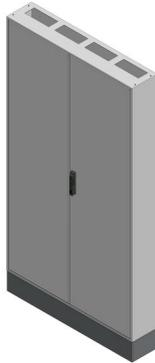
L-SVB4-12-210 Leergehäuse Standverteilung, SVB, BxHxT = 1050x1850+150x210 Schutzklasse I, IP41, RAL 7035 Bestehend aus: Gehäuse, Sockel, Doppeltür mit Schwenkhebel für PHZ, Wandhalterung, ohne Flansche
