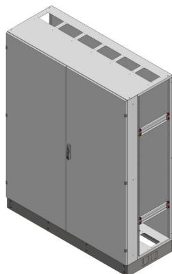
L-RSVK6-12-600 Leergehäuse Reihenschaltschrank, RSVK, BxHxT = 1570x1870+130x600 Schutzklasse II, IP54, RAL 7035 offene Seitenwände, Seitenwandprofil gekantet, für Schrankverbindung Bestehend aus: Gehäuse, Sockel, Doppeltür mit Schwenkhebel für PHZ, Wandhalterung, ohne Flansche
