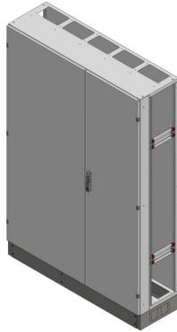
L-RSVK5-12-400 Leergehäuse Reihenschaltschrank, RSVK, BxHxT = 1320x1870+130x400 Schutzklasse II, IP54, RAL 7035 offene Seitenwände, Seitenwandprofil gekantet, für Schrankverbindung Bestehend aus: Gehäuse, Sockel, Doppeltür mit Schwenkhebel für PHZ, Wandhalterung, ohne Flansche
