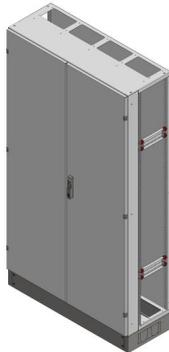
L-RSVK4-12-400 Leergehäuse Reihenschaltschrank, RSVK, BxHxT = 1070x1870+130x400 Schutzklasse II, IP54, RAL 7035 offene Seitenwände, Seitenwandprofil gekantet, für Schrankverbindung Bestehend aus: Gehäuse, Sockel, Doppeltür mit Schwenkhebel für PHZ, Wandhalterung, ohne Flansche
