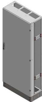
L-RSVK3-12-360 Leergehäuse Reihenschaltschrank, RSVK, BxHxT = 820x1870+130x360 Schutzklasse II, IP54, RAL 7035 offene Seitenwände, Seitenwandprofil gekantet, für Schrankverbindung Bestehend aus: Gehäuse, Sockel, Einzeltür mit Schwenkhebel für PHZ, Wandhalterung, ohne Flansche
