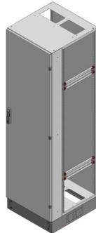
L-RSVK2-12-600 Leergehäuse Reihenschaltschrank, RSVK, BxHxT = 570x1870+130x600 Schutzklasse II, IP54, RAL 7035 offene Seitenwände, Seitenwandprofil gekantet, für Schrankverbindung Bestehend aus: Gehäuse, Sockel, Einzeltür mit Schwenkhebel für PHZ, Wandhalterung, ohne Flansche
