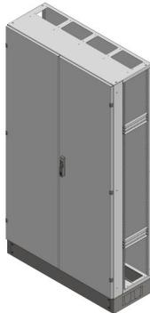
L-RSVB4-12-400 Leergehäuse Reihenschaltschrank, RSVB, BxHxT = 1070x1870+130x400 Schutzklasse I, IP54, RAL 7035 offene Seitenwände, Seitenwandprofil gekantet, für Schrankverbindung Bestehend aus: Gehäuse, Sockel, Doppeltür mit Schwenkhebel für PHZ, Wandhalterung, ohne Flansche
