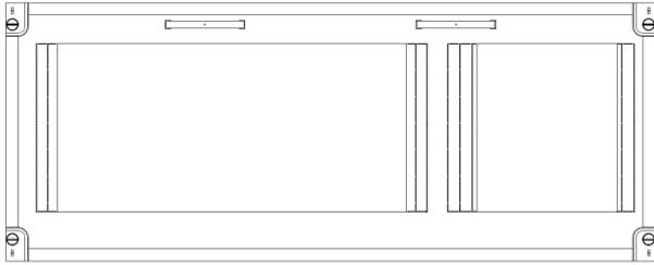
FAS32NEO-re Feldabdeckung Sammelschienensystem 3-Feld rechts Bestehend aus: 1x Feldabdeckung, 1x Haltegriff (1-Feld, 2-Feld) bzw. 2x Haltegriff (3-Feld), 4x Vierteldrehverschluss
