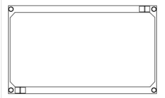
FAG22PS Feldabdeckung PS 500x300 geschlossen Polystyrol, RAL 7035
