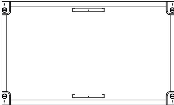
FAG22PRL Feldabdeckung PRL 500x300 geschlossen Polystyrol, RAL 7035,
