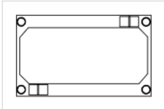
FAG11PS Feldabdeckung PS 250x150 geschlossen Polystyrol, RAL 7035 Bestehend aus: 1x Feldabdeckung, 4x Vierteldrehverschluss
