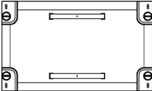
FAG11PRL Feldabdeckung PRL 250x150 geschlossen Polystyrol, RAL 7035,
