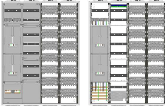
AZ82HS2AM4-230, Zählerverteilung mit 3-Punktnach VDE 0603, DIN43870, AR-N 4101:2015 für den Innenbereich für Wandbefestigung AP/UP, Fabr. Alphatec, BxHxT [mm] = 1050x1400x230, Schutzklasse II, IP54, RAL 7035, Bestehend aus: Gehäuse, Einzel- bzw. Doppeltür mit Drehriegel, Flansche SF45 (oben) und SF41 (unten) und Berührungsschutzabdeckungen, aufgebaut wie folgt: 2xZählerplatz, Verteilerfeld (12TE), APZ in Verteilerfeld, Medienfeld, komplett zusammengebaut und verdrahtet gemäß VNB.0192
