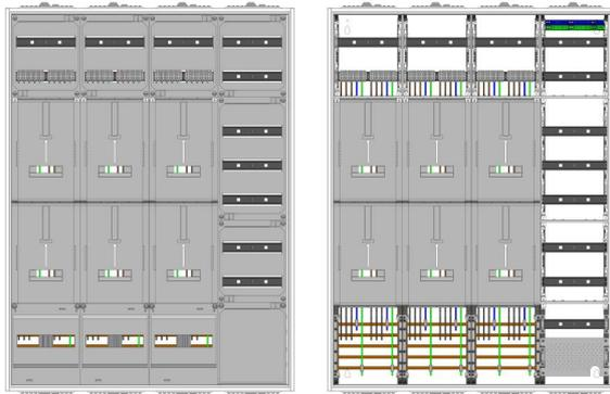
AZ82HS2A-230-6, Zählerverteilung mit 3-Punktnach VDE 0603, DIN43870, AR-N 4101:2015 für den Innenbereich für Wandbefestigung AP/UP, Fabr. Alphatec, BxHxT [mm] = 1050x1400x230, Schutzklasse II, IP54, RAL 7035, Bestehend aus: Gehäuse, Einzel- bzw. Doppeltür mit Drehriegel, Flansche SF45 (oben) und SF41 (unten) und Berührungsschutzabdeckungen, aufgebaut wie folgt: 6xZählerplatz, Verteilerfeld (12TE), APZ in Verteilerfeld, komplett zusammengebaut und verdrahtet gemäß VNB.0190
