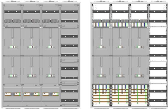
AZ82HS2-230-6, Zählerverteilung mit 3-Punktnach VDE 0603, DIN43870, AR-N 4101:2015 für den Innenbereich für Wandbefestigung AP/UP, Fabr. Alphatec, BxHxT [mm] = 1050x1400x230, Schutzklasse II, IP54, RAL 7035, Bestehend aus: Gehäuse, Einzel- bzw. Doppeltür mit Drehriegel, Flansche SF45 (oben) und SF41 (unten) und Berührungsschutzabdeckungen, aufgebaut wie folgt: 6xZählerplatz, Verteilerfeld (12TE), externer APZ erforderlich, komplett zusammengebaut und verdrahtet gemäß VNB.0143
