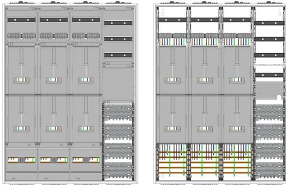
AZ82HS1AM1-230, Zählerverteilung mit 3-Punktnach VDE 0603, DIN43870, AR-N 4101:2015 für den Innenbereich für Wandbefestigung AP/UP, Fabr. Alphatec, BxHxT [mm] = 1050x1400x230, Schutzklasse II, IP54, RAL 7035, Bestehend aus: Gehäuse, Einzel- bzw. Doppeltür mit Drehriegel, Flansche SF45 (oben) und SF41 (unten) und Berührungsschutzabdeckungen, aufgebaut wie folgt: 5xZählerplatz, TSG, APZ in Medienfeld, komplett zusammengebaut und verdrahtet gemäß VNB.0187
