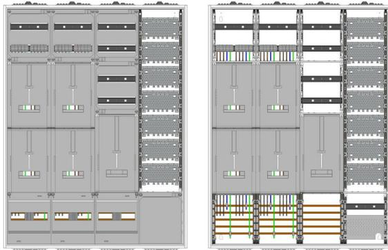
AZ82HM2A-210, Zählerverteilung mit 3-Punktbefestigung nach VDE 0603, DIN43870, AR-N 4101:2015 für den Innenbereich für Wandbefestigung AP/UP, Fabr. Alphatec, BxHxT [mm] = 1050x1400x210, Schutzklasse II, IP41, RAL 9016, Bestehend aus: Gehäuse, Einzel- bzw. Doppeltür mit Drehriegel, Flansche NF1 (oben) und NF2 (unten) und Berührungsschutzabdeckungen, aufgebaut wie folgt: 4xZählerplatz, TSG, APZ in Medienfeld, komplett zusammengebaut und verdrahtet gemäß VNB.0064
