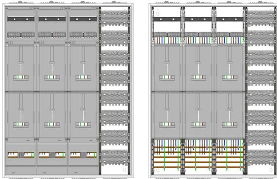
AZ82HM2-230-2, Zählerverteilung mit 3-Punktnach VDE 0603, DIN43870, AR-N 4101:2015 für den Innenbereich für Wandbefestigung AP/UP, Fabr. Alphatec, BxHxT [mm] = 1050x1400x230, Schutzklasse II, IP54, RAL 7035, Bestehend aus: Gehäuse, Einzel- bzw. Doppeltür mit Drehriegel, Flansche SF45 (oben) und SF41 (unten) und Berührungsschutzabdeckungen, aufgebaut wie folgt: 6xZählerplatz, Medienfeld, externer APZ erforderlich, komplett zusammengebaut und verdrahtet gemäß VNB.0184
